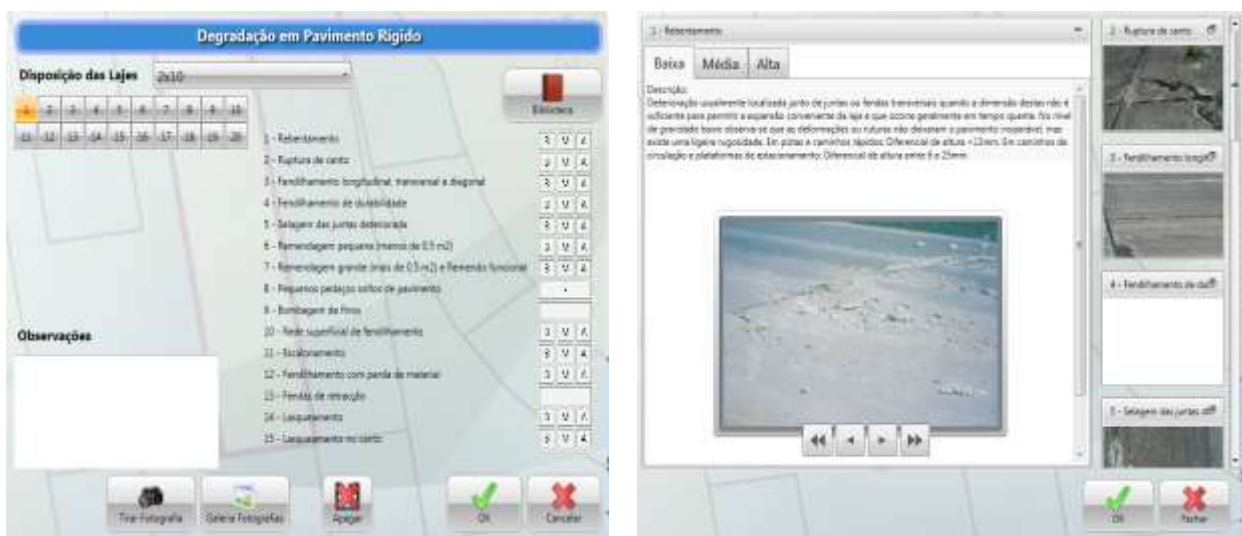
Figura 2.6 – Software utilizado na inspeção visual (DECIVIL)
