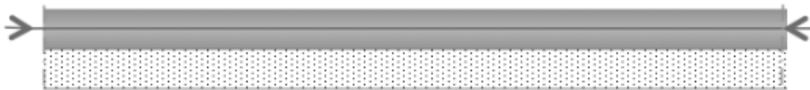
Figura 2.5 – Pavimento de betão armado pré-esforçado (elaboração própria – adaptado de Picado Santos et al, 2011)
